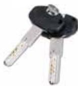
**½ cilindro interno di sicurezza antitrapano, con chiave da cantiere per la posa e busta sigillata contenente n.2 chiavi padronali che annullano automaticamente la chiave da cantiere, e la card per la duplicazione delle chiavi. Ogni abitazione avrà la chiave unificata.**
